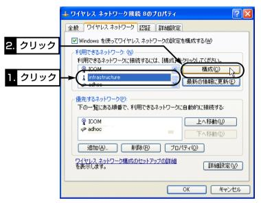
**4.**ネットワークキー(WEP)の設定が必要なときは、選択した無線ネットワーク 名の機器に設定されたキーと同じものを[ネットワーク キー(<u>K</u>)]と[ネットワークキーの確認入力(O)]に入力してから、〈OK〉をクリックします。
